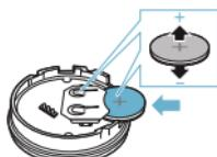
3. Složte zpět horní a dolní část obalu. Ujistěte se, že jsou kontaktní spony správně umístěny.
