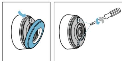
2. Odstráňte hornú časť obalu. Vyberte staré batérie. Vložte dovnútra nové batérie. Dbajte na správnu polaritu batérií.
