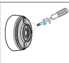
2. Odstraňte horní část obalu. Vyměte starou baterie. Vložte dovnitř nové baterie. Dbejte na správnou polaritu baterií.
