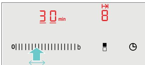
Začne sa odpočítavať čas prípravy pokrmu. Pokiaľ ste nastavili čas prípravy pokrmu pre viac ako jednu varnú zónu, na displeji sa vždy zobrazí čas prípravy pokrmu pre zvolenú varnú zónu.
