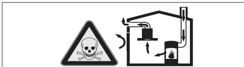
Zdroje kúrenia závislé od prívodu vzduchu z miestnosti (napr. vykurovacie telesá na plyn, drevo alebo uhlíe, prietokový ohrievač, ohrievač vody) odoberajú vzduch pre spaľovanie z miestnosti, kde sú umiestnené, a odvádzajú spaliny von výfukovým systémom (napr. komín).
