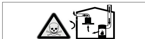
Zdroje topení závislé na přívodu vzduchu z místnosti (např. topná tělesa na plyn, dřevo nebo uhlí, průtokový ohřívač, ohřívač vody) odebrájí vzduch pro spalování z místnosti, kde jsou umístěny, a odvádějí spalinu ven výfukovým systémem (např. komín).
