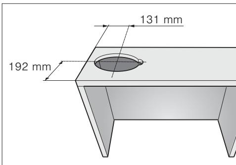
2. Odstráňte dno skrinky, ak je k dispozícii. Označte si na vnútorných stranach skrinky upevňovacie body a urobte vpichy vhodným nástrojom. Na označenie upevňovacích bodov použite priloženú šablónu. A
