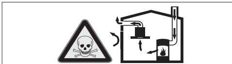
Zdroje kúrenia závislé od prívodu vzduchu z miestnosti (napr. vykurovacie telesá na plyn, drevo alebo uhlí, prietokový ohrievač, ohrievač vody) odoberajú vzduch pre spaľovanie z miestnosti, kde sú umiestnené, a odvádzajú spaliny von výfukovým systémom (napr. komín).
