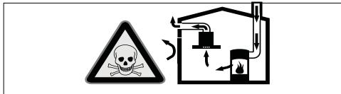
Zdroje topení závislé na přívodu vzduchu z místnosti (např. topná tělesa na plyn, dřevo nebo uhlí, průtokový ohřívač, ohřívač vody) oddebírají vzduch pro spalování z místnosti, kde jsou umístěné, a odvádějí spaliny ven výfukovým systémem (např. komín).
