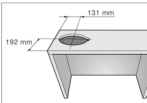
2. Odstraňte dno skřínky, pokud je k dispozici. Naznačte si na vnitřních stranách skřínky připevňovací body a udělejte vpichy vhodným nástrojem. K naznačení připevňovacích bodů použijte přiloženou šablónu. **A**
