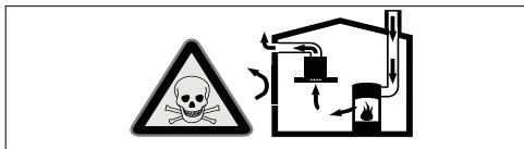
Zdroje topení závislé na přívodu vzduchu z místnosti (např. topná tělesa na plyn, dřevo nebo uhlí, průtokový ohřívač, ohřívací vody) odebírají vzduch pro spalování z místnosti, kde jsou umístěny, a odvádějí spaliny ven výfukovým systémem (např. komín).
