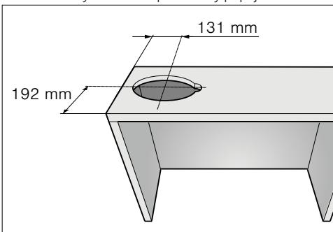
2. Odstráňte dno skrinky, ak je k dispozícii. Označte si na vnútorných stranach skrinky upevňovacie body a urobte vŕpy vhodným nástrojom. Na označenie upevňovacích bodov použite priloženú šablónu A.
