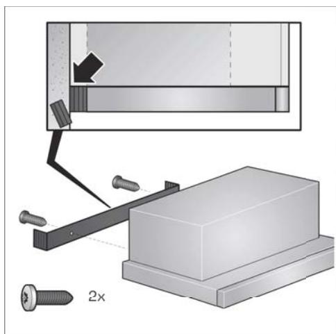
5. Prístroj opäť zaveste, vyrovnejte ho a pevne ho priskrutkujte. Opatrne utiahnite všetky skrutky.
