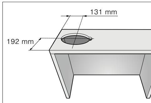
2. Odstraňte dno skřínky, pokud je k dispozici. Naznačte si na vnitřních stranách skřínky připevňovací body a udělejte vpichy vhodným nástrojem. K naznačení připevňovacích bodů použijte přiloženou šablounu. **A**
