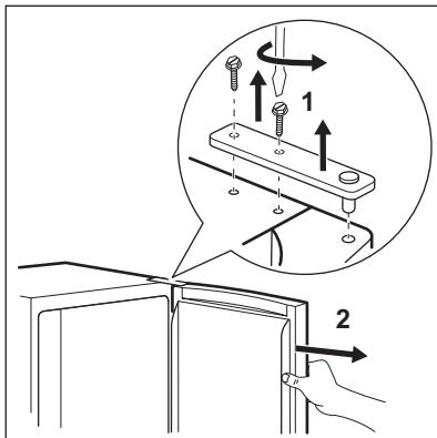
3. Entfernen Sie die Tür aus dem Stift des mittleren Scharniers (2).
