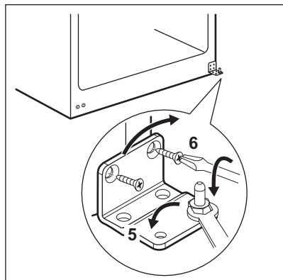
9. Lösen Sie die Schrauben des unteren Türscharniers und entfernen Sie das Scharnier (8).
