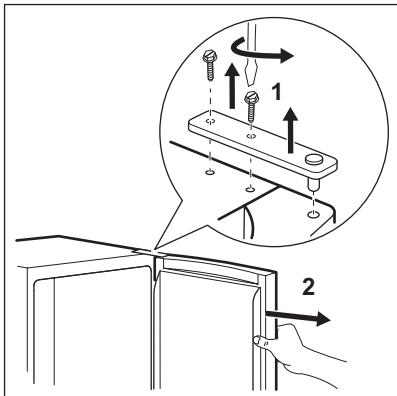
3. Verwijder de deur van de draaiopen van het middelste scharnier (2).
