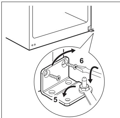
9. Schroef de schroeven van het onderste scharnier los en verwijder het scharnier (8).
