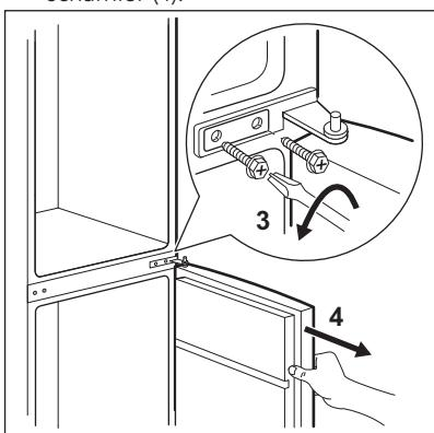
8. Schroef de draaiopen van het onderste scharnier (5) los en schroef de draaiopen van het onderste scharnier (6) in het linker gat van het onderste scharnier.
