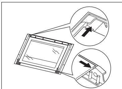
Po ukončení čistenia namontujte sklenený panel a dvierka rúry. Pri montáži zvolte opačný postup. Povrch s potlačou musí smerovať do vnútra dvierok. Po montáži skontrolujte, či nie je povrch skleneného panela na mieste potlače na dotyk drsný. Uistite sa, že ste vnútorný sklenený panel nainstalovali do lôžok správne. Pozrite si uvedený obrázok.
