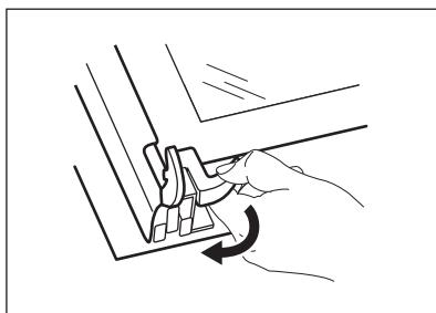
5. Uvolněte blokovací systém a vytáhněte vnitřní skleněný panel.
