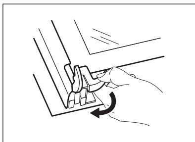
5. Uvoľnite blokovací systém, aby sa dal vybrať vnútorný sklenený panel.
