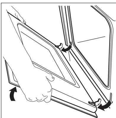
3. Přivřete dvířka trouby do první polohy otevření (do poloviny). Pak dvířka vytáhněte směrem dopředu z jejich umístění.
